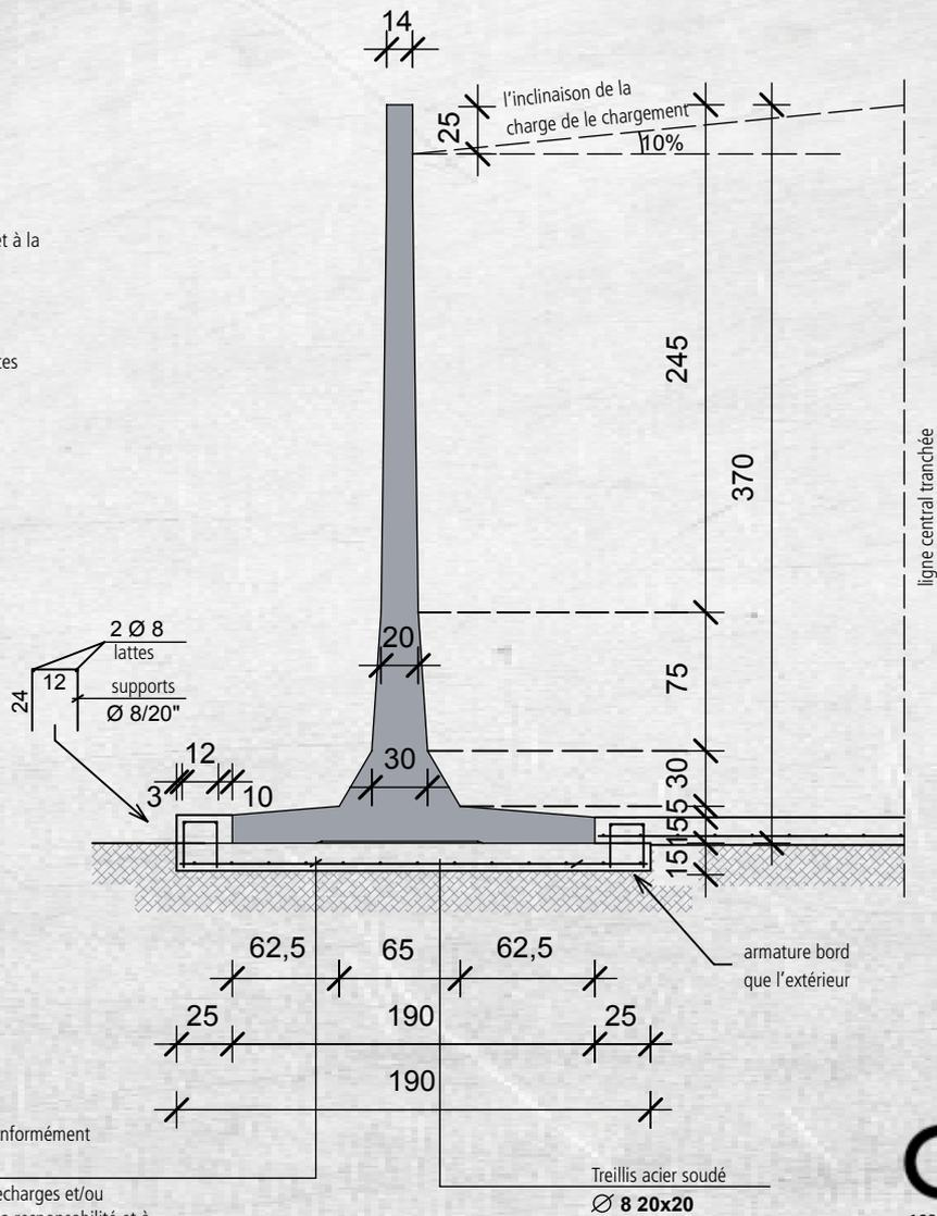
Fondations en béton à réaliser sur le site. L'épaisseur est de 15 cm par portée de terrain, conformément aux prescriptions indiquées dans le tableau.
